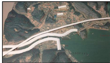
現在提示されている計画案に基づき、宮城大学平岡研究室が作成した模型を全体で確認し、防潮堤・河川堤防・国道の位置関係を共有しました。
